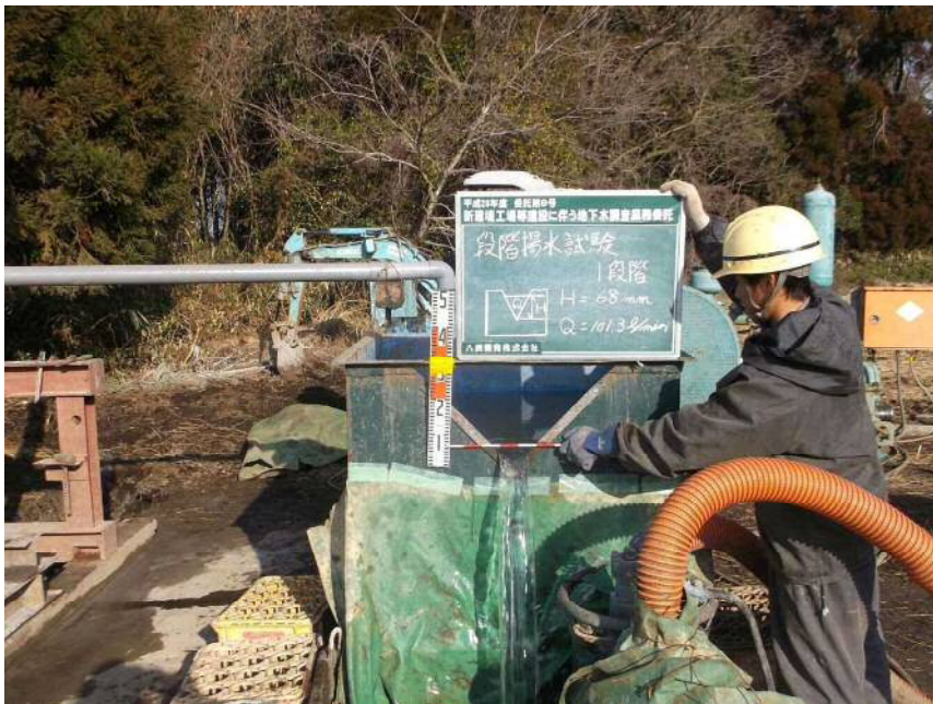
段階揚水試験 1段階 ノッチ高=68mm 揚水量=101.3ℓ/min
