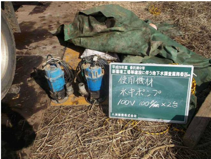
使用機材 水中ポンプ 100V 100ℓ/min × 2台
