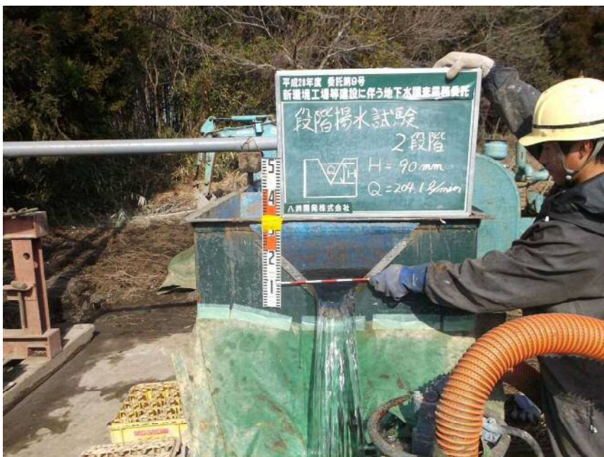
段階揚水試験 2段階 ノッチ高=90mm 揚水量=204.1ℓ/min
