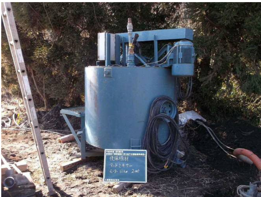
使用機材 マッドミキサー モーター 11kw 2m3
