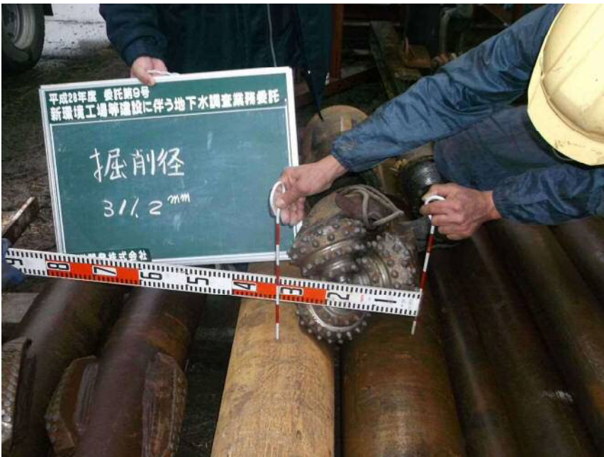
掘削径 φ 311.2mm 51.00m～131.00mまで
