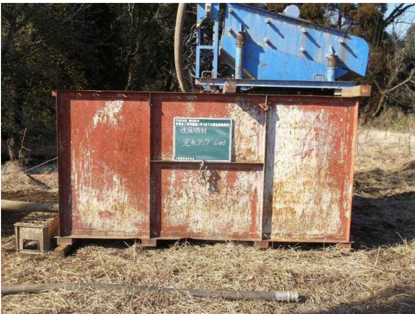
使用機材 泥水タンク 6m 3
