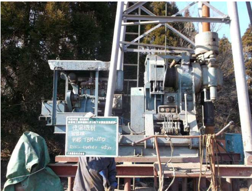
使用機材 試錐機 利根TBM-150 エンジン ミツイドイツ 45PS
