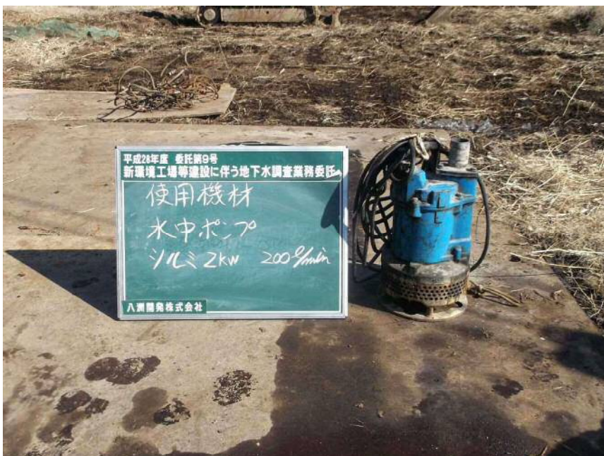
使用機材 水中ポンプ ツルミ 2kw 200ℓ/min
