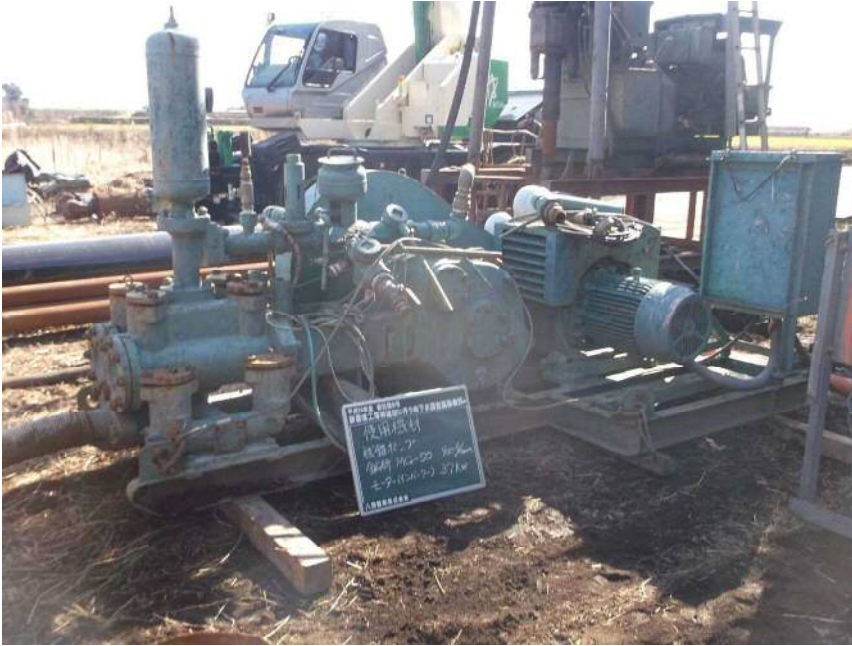
使用機材 試錐ポンプ 鉦研MG-50 9000/min モーター (インバーター) 37kw
