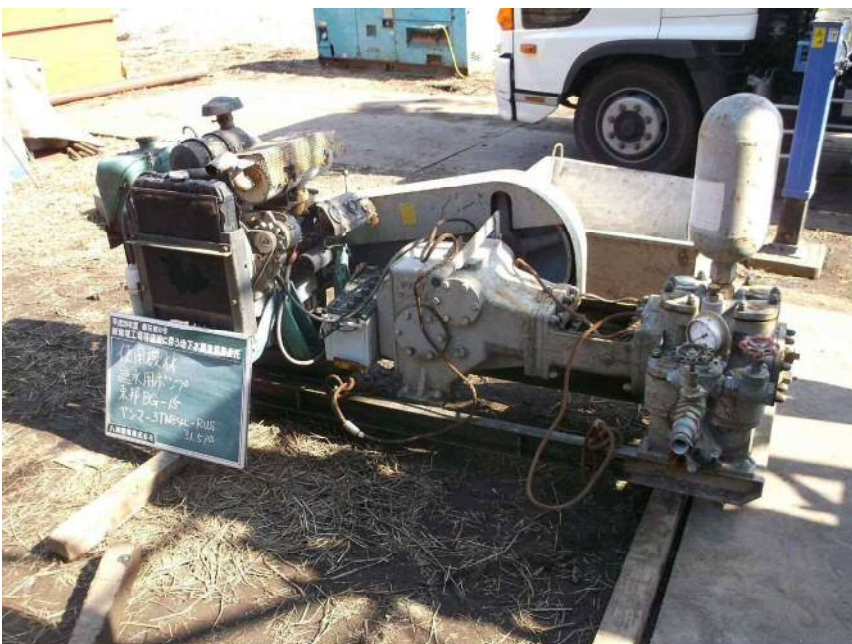
使用機材 遮水用ポンプ 東邦BG-15 ヤンマー3TN84L-RUS (31.5PS)
