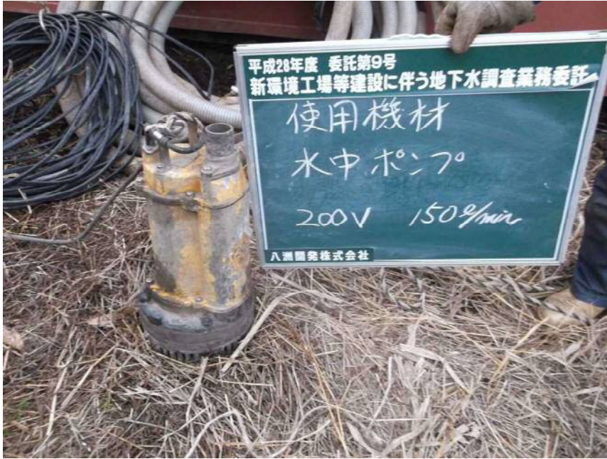
使用機材 水中ポンプ 200V 150ℓ/min
