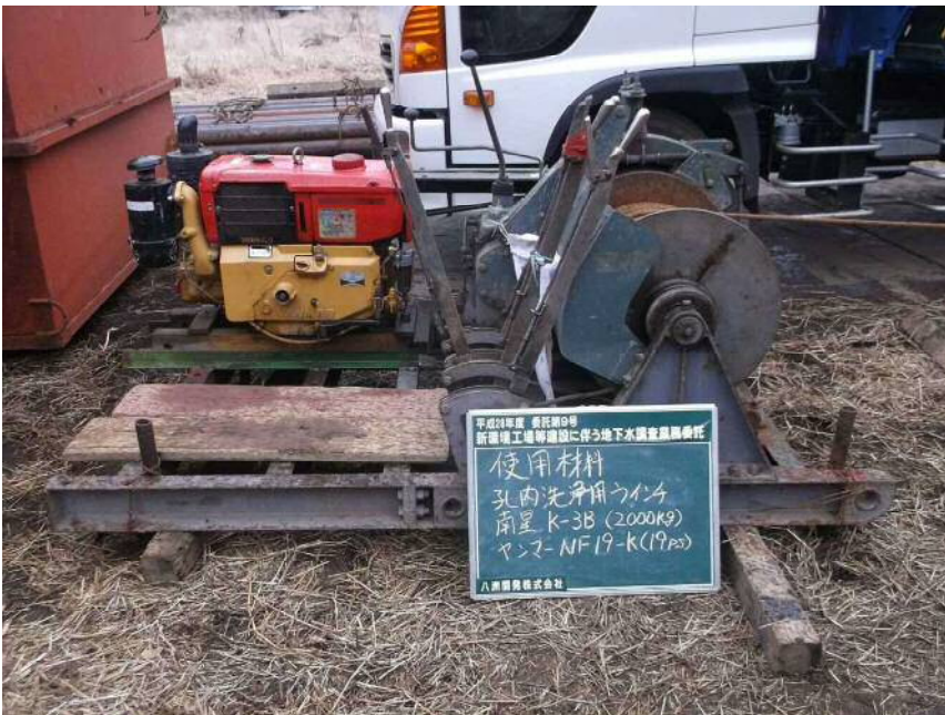
使用機材 孔内洗浄用ウインチ 南星K-3B (2000kg) ヤンマーNF19-K (19PS)
