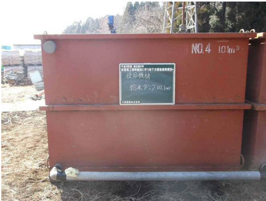
使用機材 給水タンク 10.1m 3
