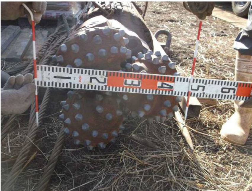
掘削径 φ444.5mm 0.00m~51.00mまで
