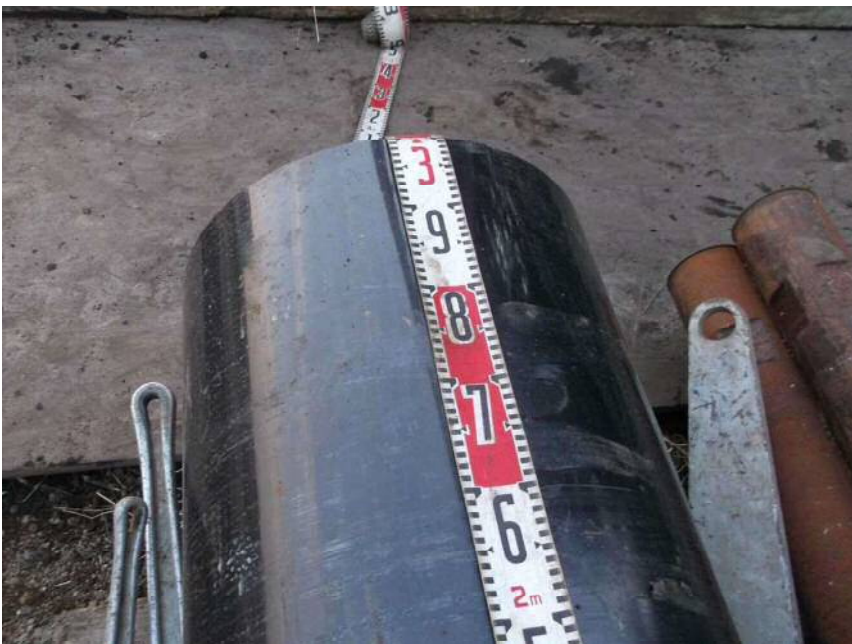
材料検収 孔口保護管 φ 500mm L=3.00m
