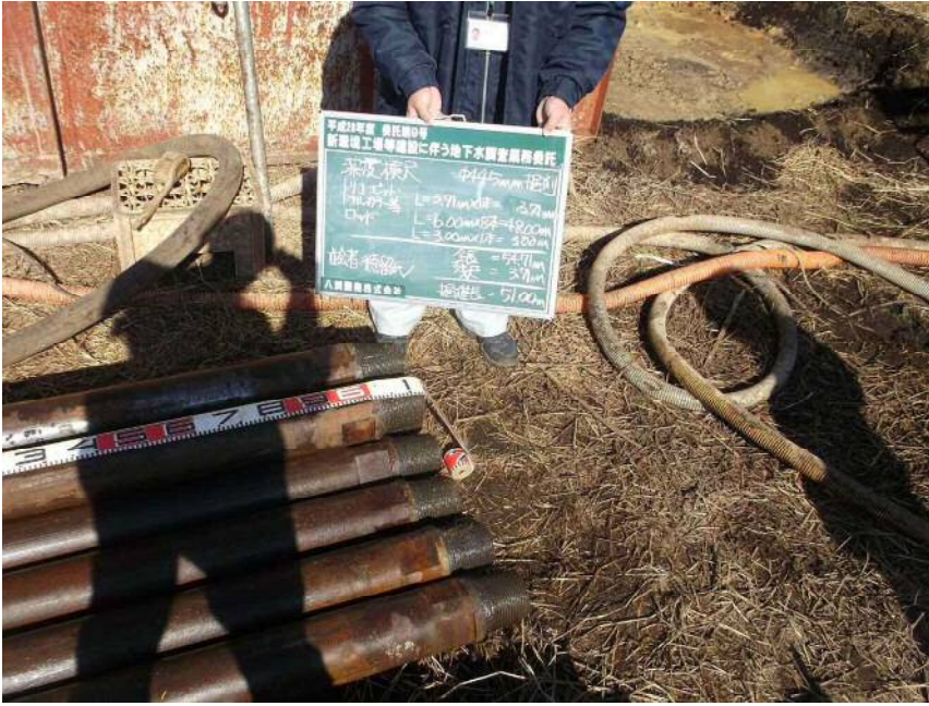
φ 444.5mm掘削 深度検尺(近景) 立会者:徳留氏 全長=54.71m 残尺 = 3.71m 深度=51.00m
