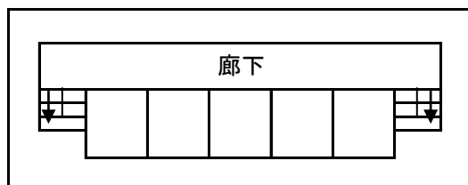
《両側に直通階段が設けられた例》
