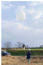
上層気象の観測 (測定機器を吊り下げた気球を放球する様子)
