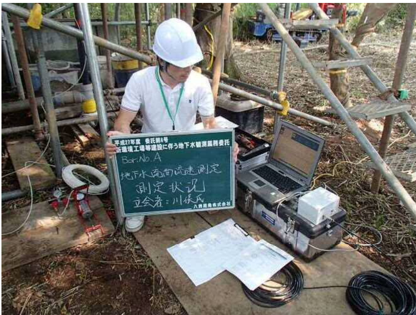
No. A 地下水流向流速測定 測定状況
