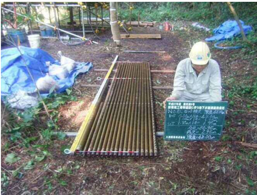
No. B 深度検尺 全長=50.95m 残尺= 2.95m 深度=48.00m
