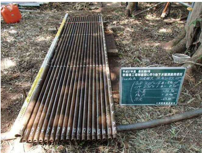
No. A 深度検尺 全長=56.90m 残尺= 3.40m 深度=53.50m
