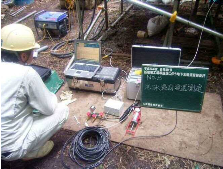
No. B 地下水流向流速測定
