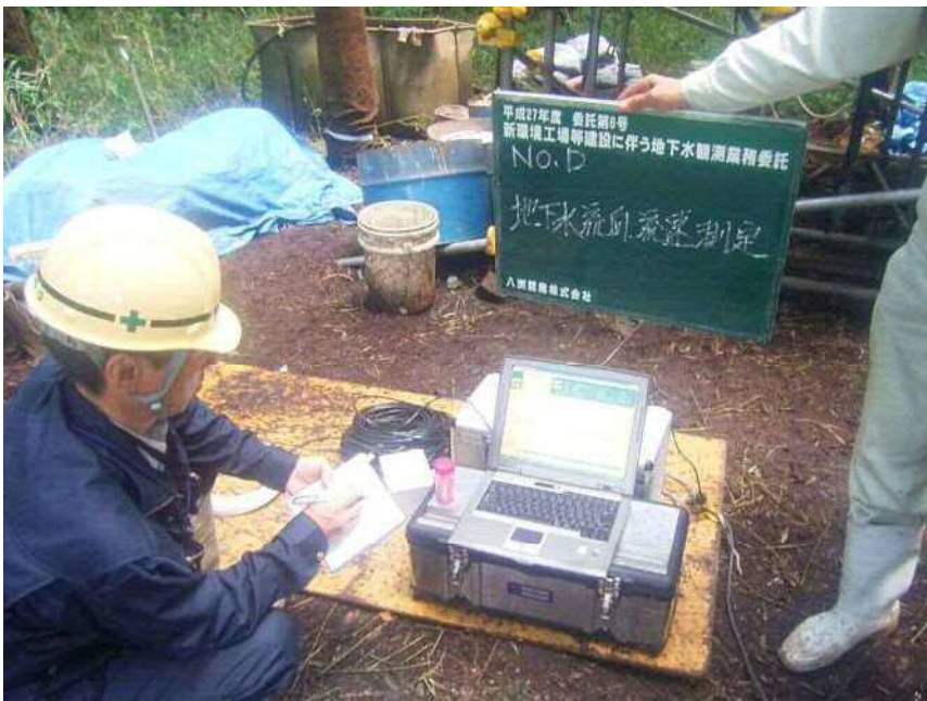
No. D 地下水流向流速測定
