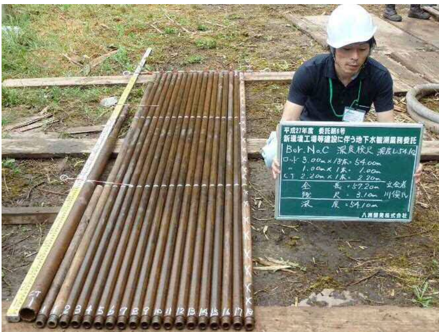
No. C 深度検尺 全長=57.20m 残尺= 3.10m 深度=54.10m
