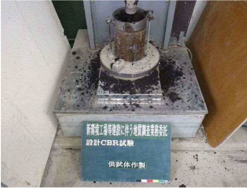
室内土質試験 設計CBR試験 供試体作製
