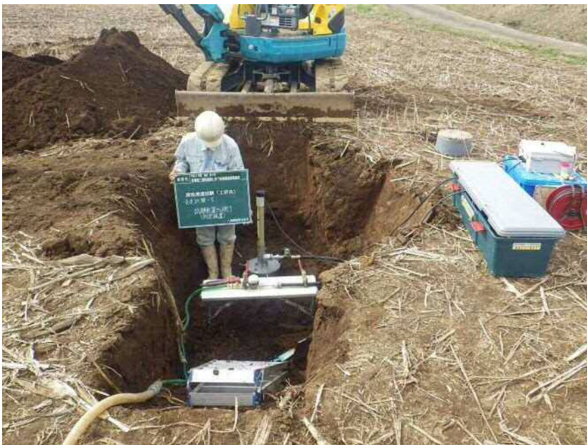
現地浸透試験(土研法)
