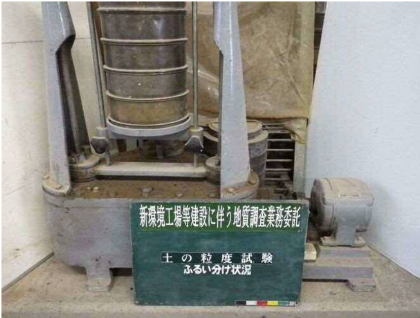
室内土質試験 土の粒度試験 ふるい分け状況
