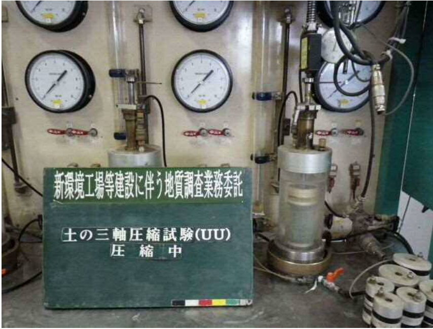
室内土質試験 土の三軸圧縮試験(UU) 圧縮中
