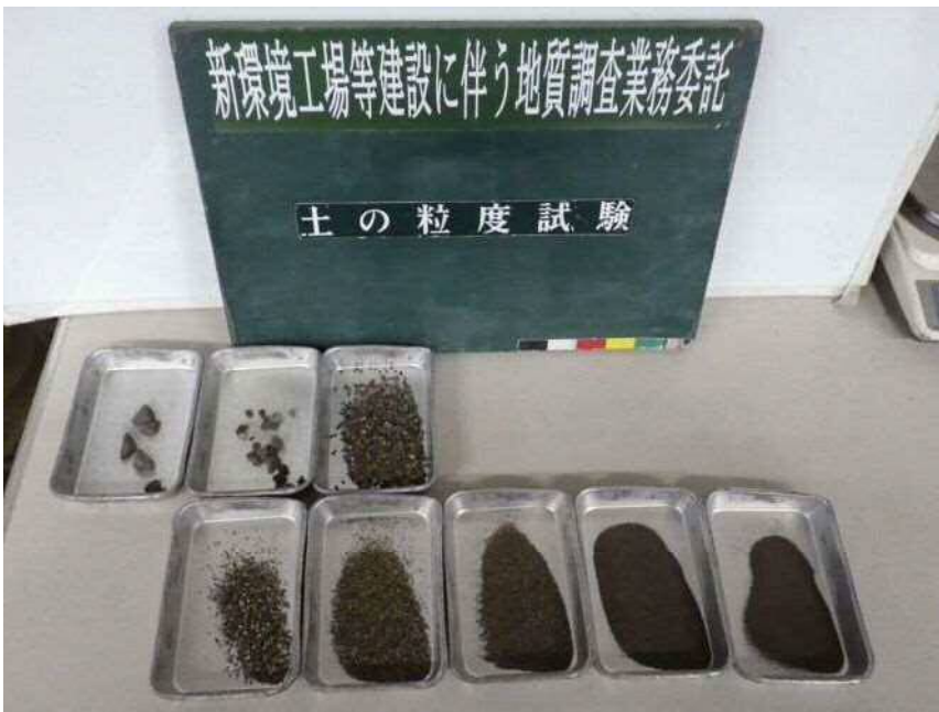
室内土質試験 土の粒度試験
