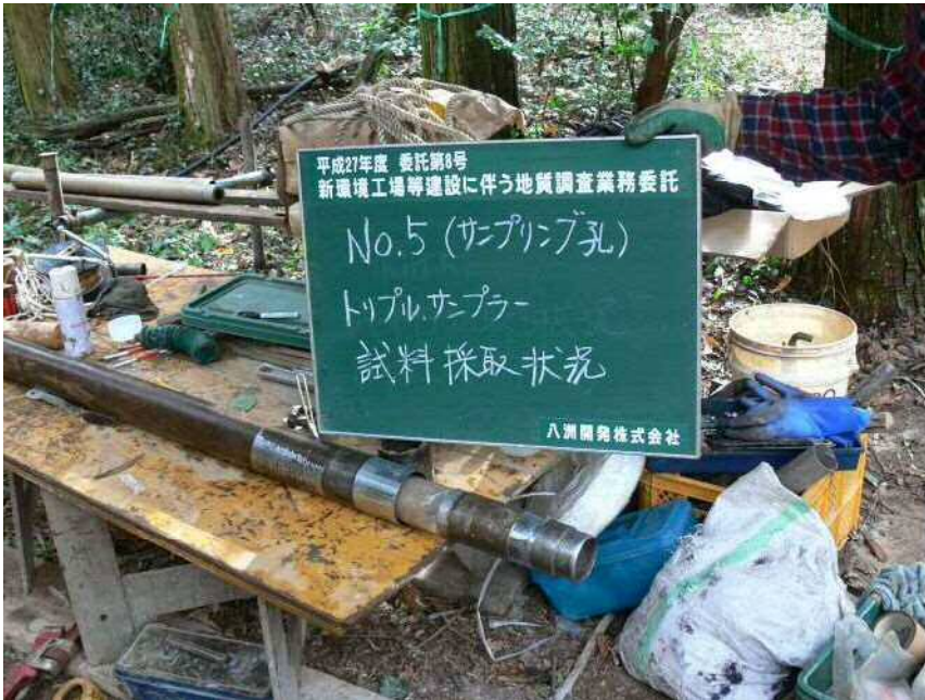
No. 5 (サンプリング孔) 試料採取状況 トリプルサンプラー
