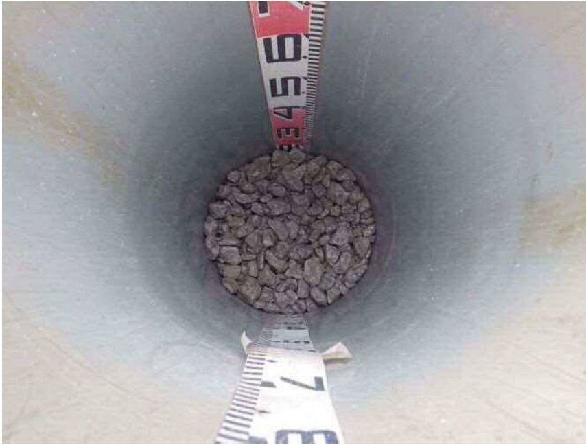
現地浸透試験(土研法)
