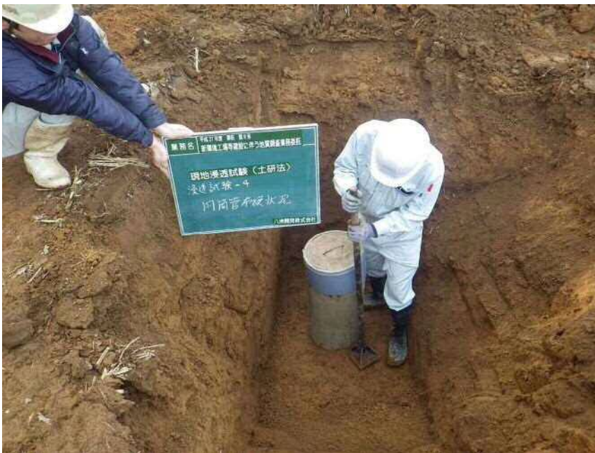
現地浸透試験(土研法)
