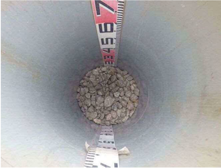
現地浸透試験(土研法)
