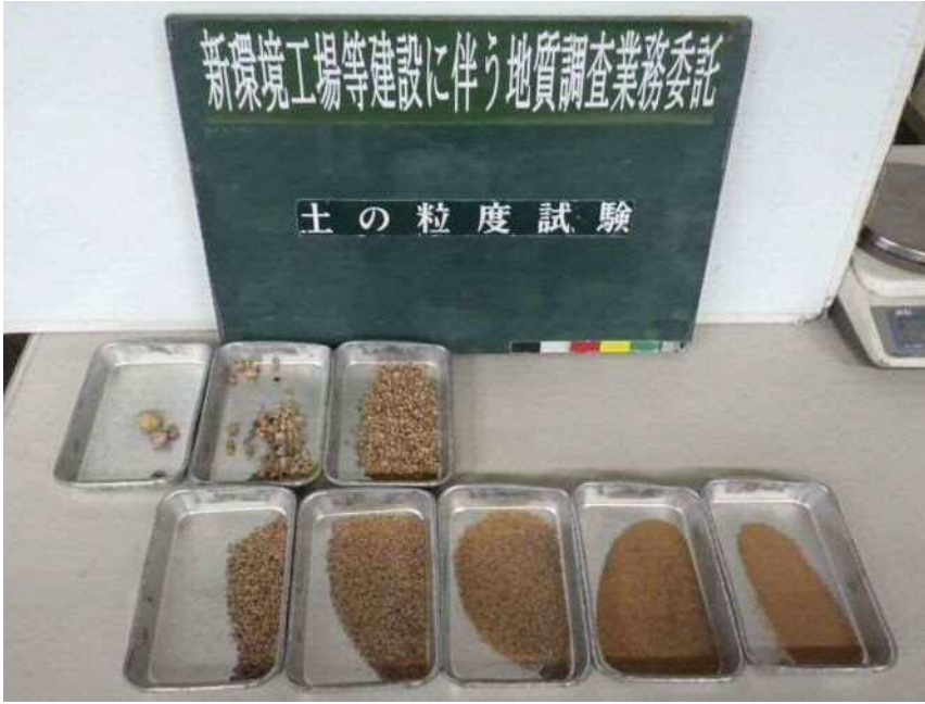
室内土質試験 土の粒度試験
