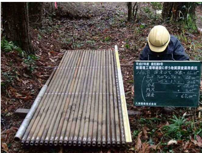
No. 8 深度検尺 全長=68.05m 残尺= 3.05m 深さ=65.00m
