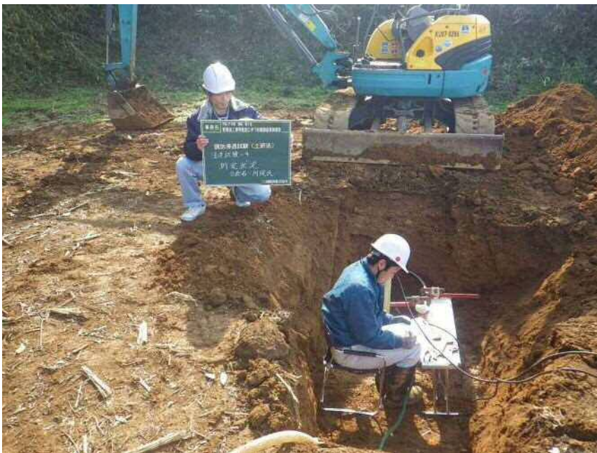
現地浸透試験(土研法)
