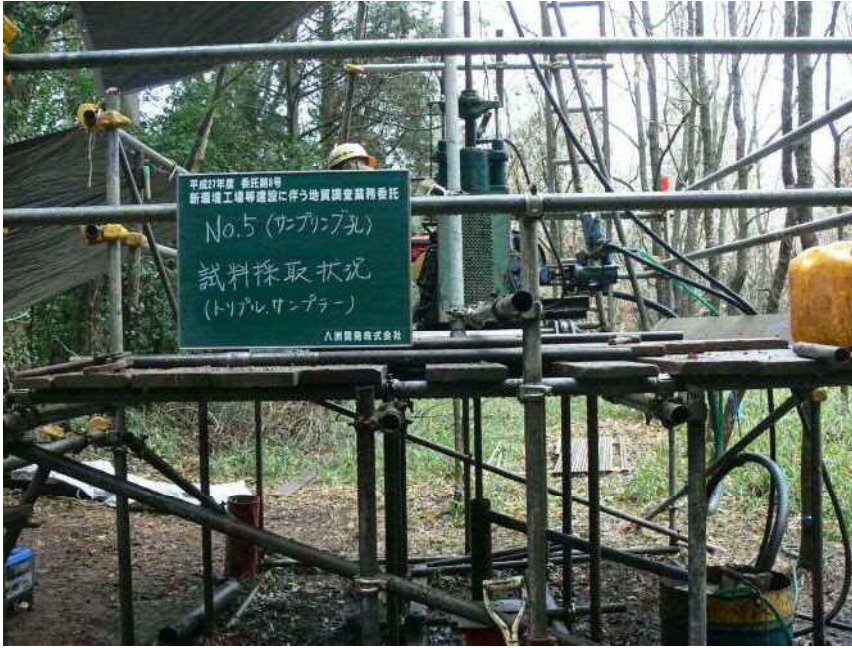
No. 5 (サンプリング孔) 試料採取状況 トリプルサンプラー
