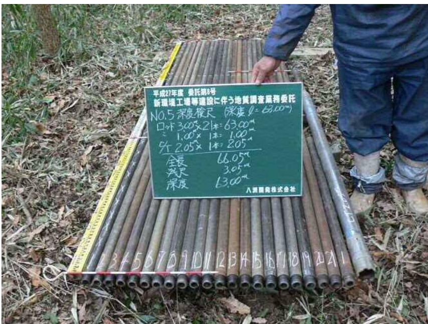
No. 5 深度検尺 全長=66.05m 残尺= 3.05m 深度=63.00m
