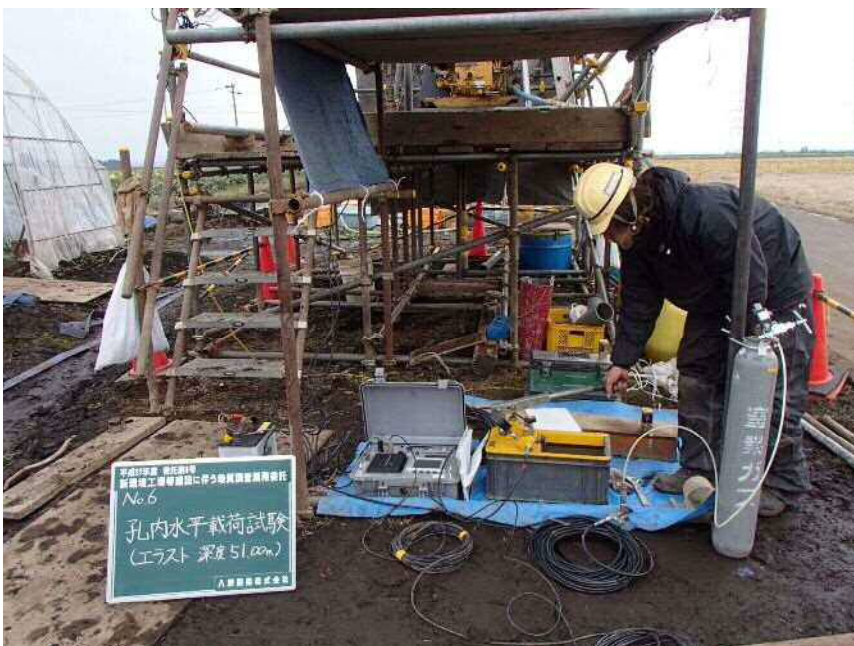
No. 6 孔内水平載荷試験 (エラストメーター) 深度=51.00m
