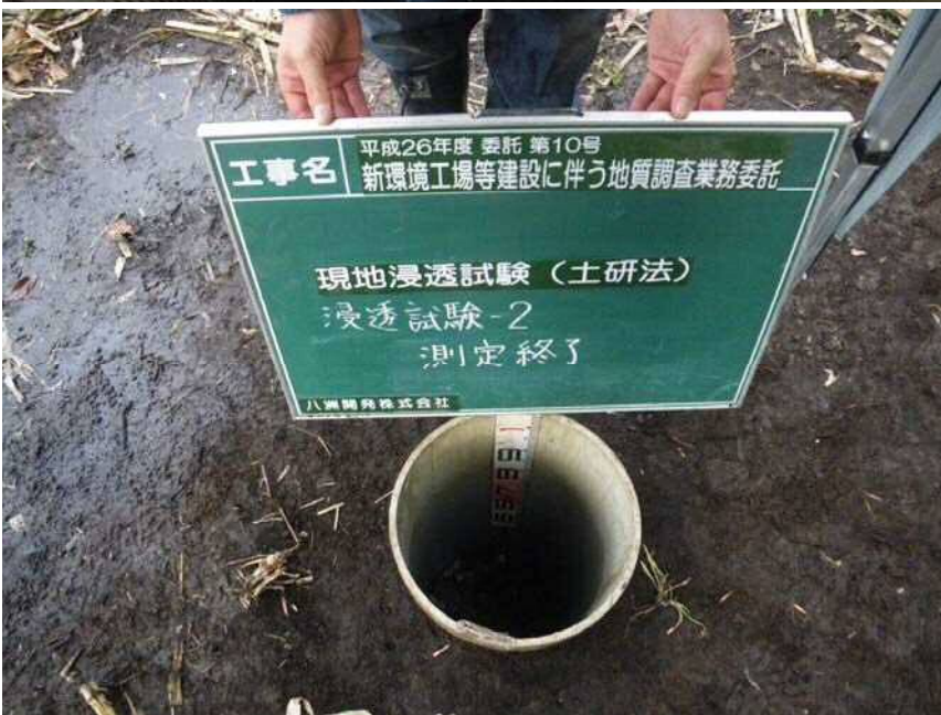
現場浸透試験(土研法)2 測定終了
