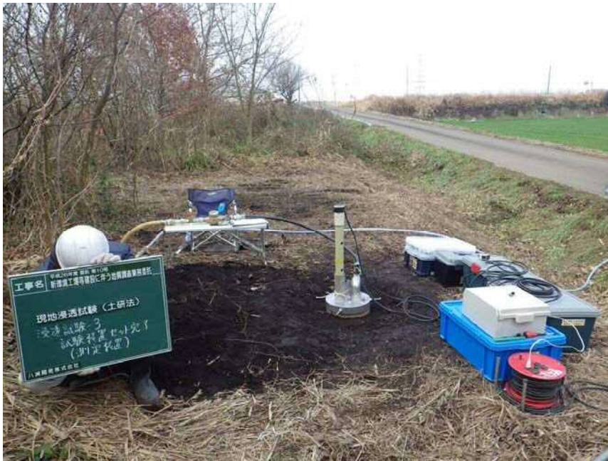
現場浸透試験(土研法)3 試験装置セット完了 測定装置
