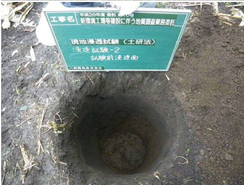
現場浸透試験(土研法)2
