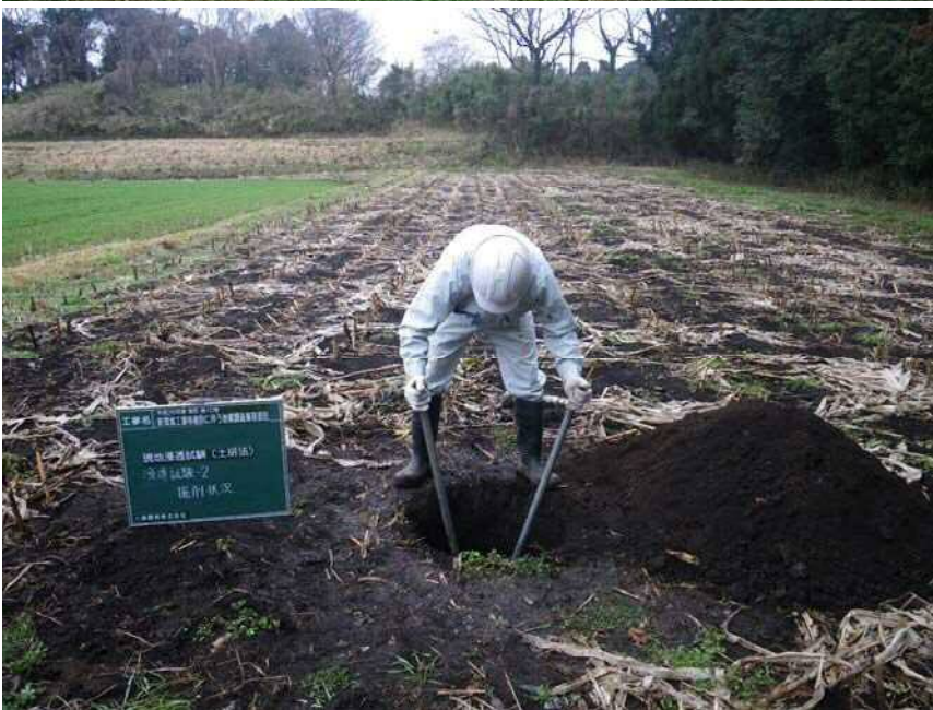
現場浸透試験(土研法)2 掘削状況
