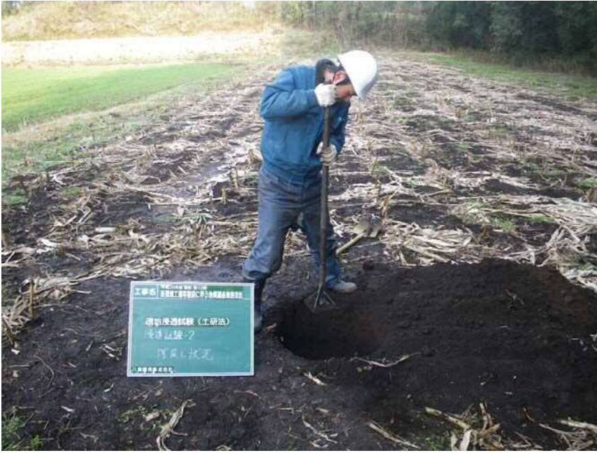
現場浸透試験(土研法)2 埋戻し状況
