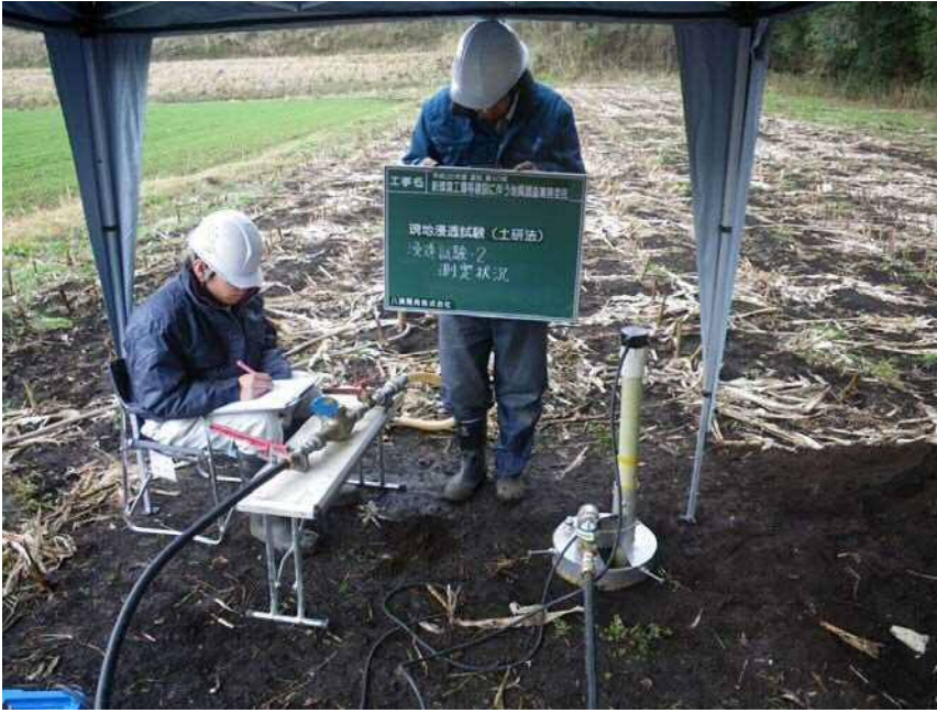
現場浸透試験(土研法)2 測定状況
