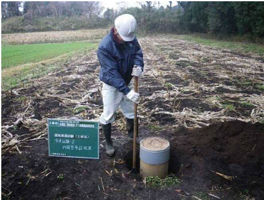
現場浸透試験(土研法)2 円筒管布設状況
