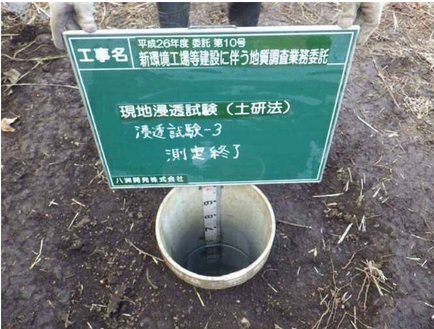
現場浸透試験(土研法)3 測定終了
