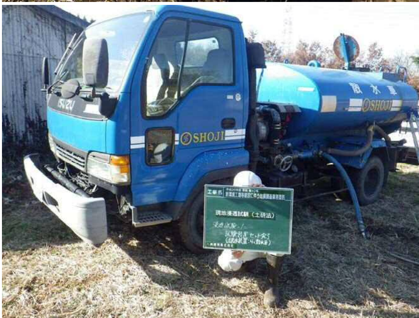
現場浸透試験(土研法)1 試験装置セット完了 送水装置、4 t 散水車
