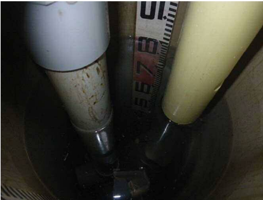
現場浸透試験(土研法)2 測定状況
