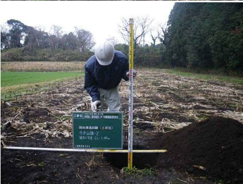
現場浸透試験(土研法)2 掘削深度 GL-1.00m
