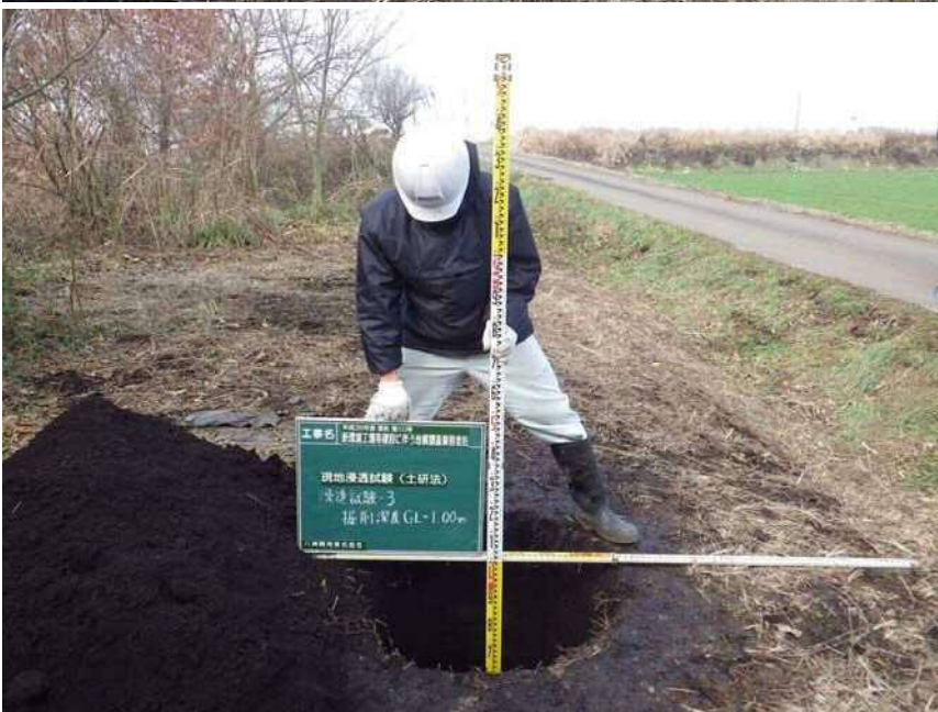
現場浸透試験(土研法)3 掘削深度 GL-1.00m
