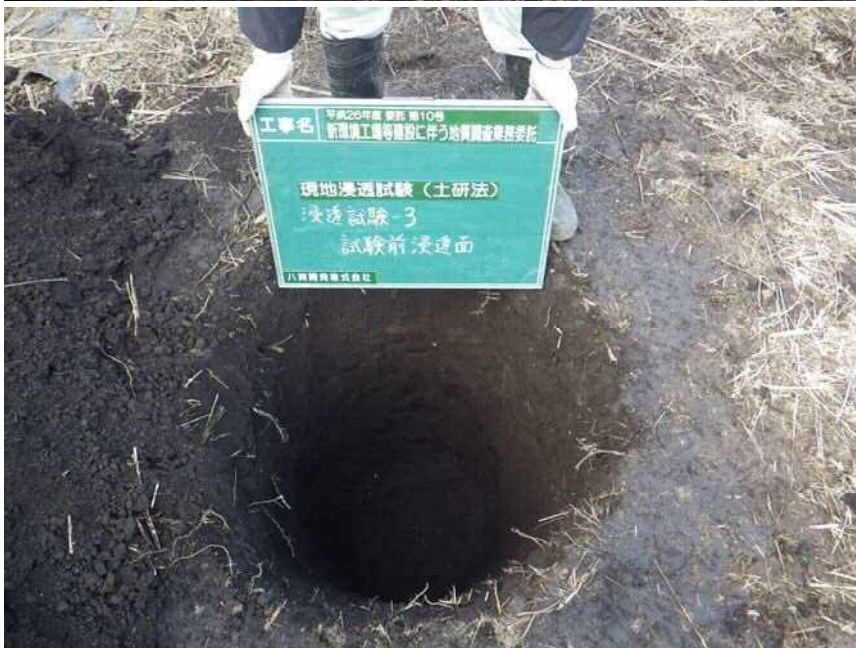
現場浸透試験(土研法)3
