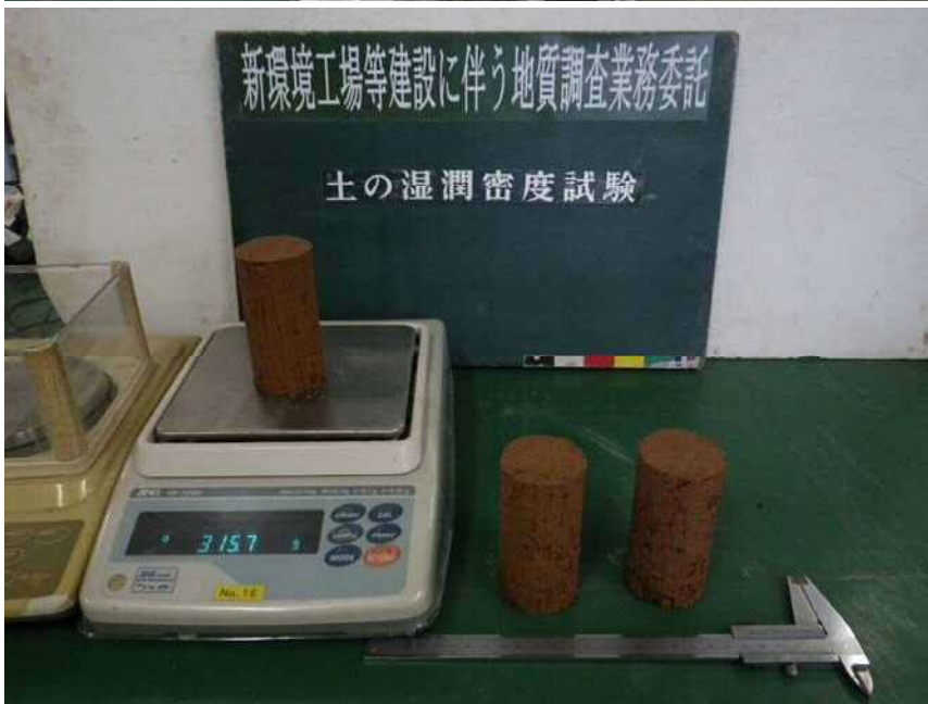
室内土質試験 土の湿潤密度試験
