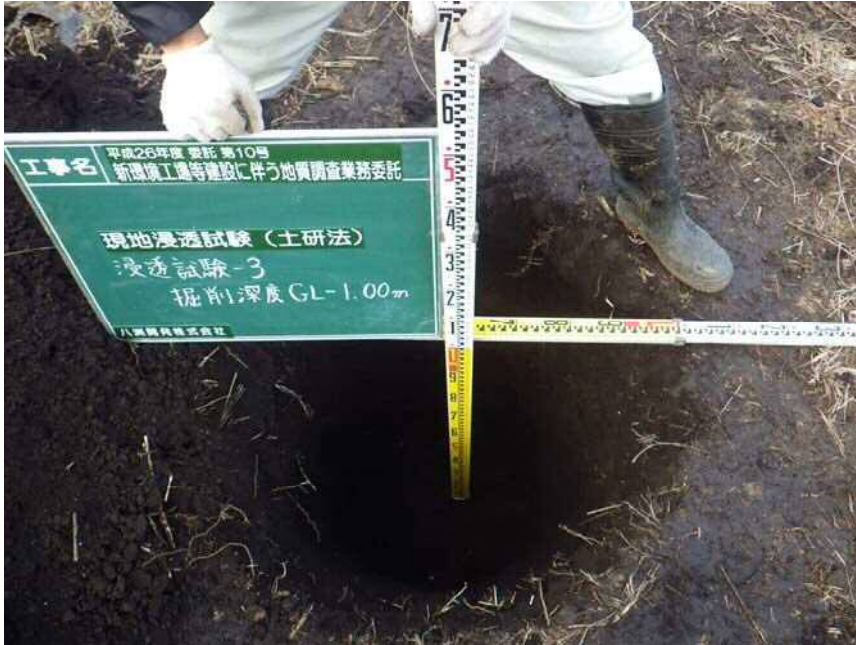
現場浸透試験(土研法)3
