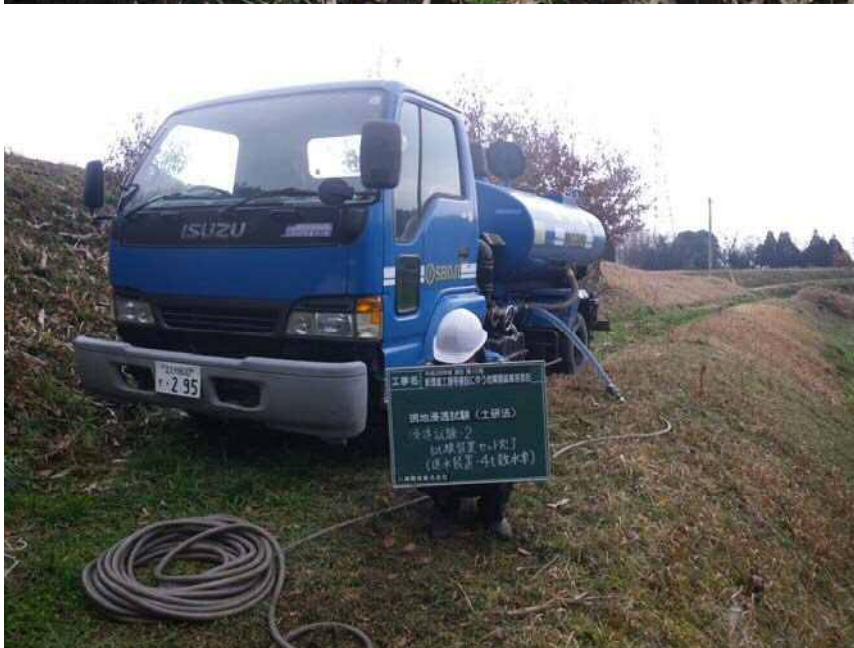
現場浸透試験(土研法)2 試験装置セット完了 送水装置、4 t 散水車
