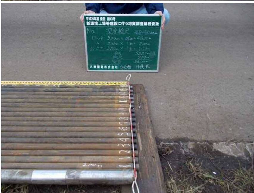
No1 ロッド検尺 全長=52.50m 残尺= 2.50m 深度=50.00m
