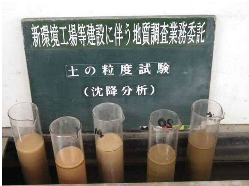
室内土質試験 土の粒度試験(沈降分析)
