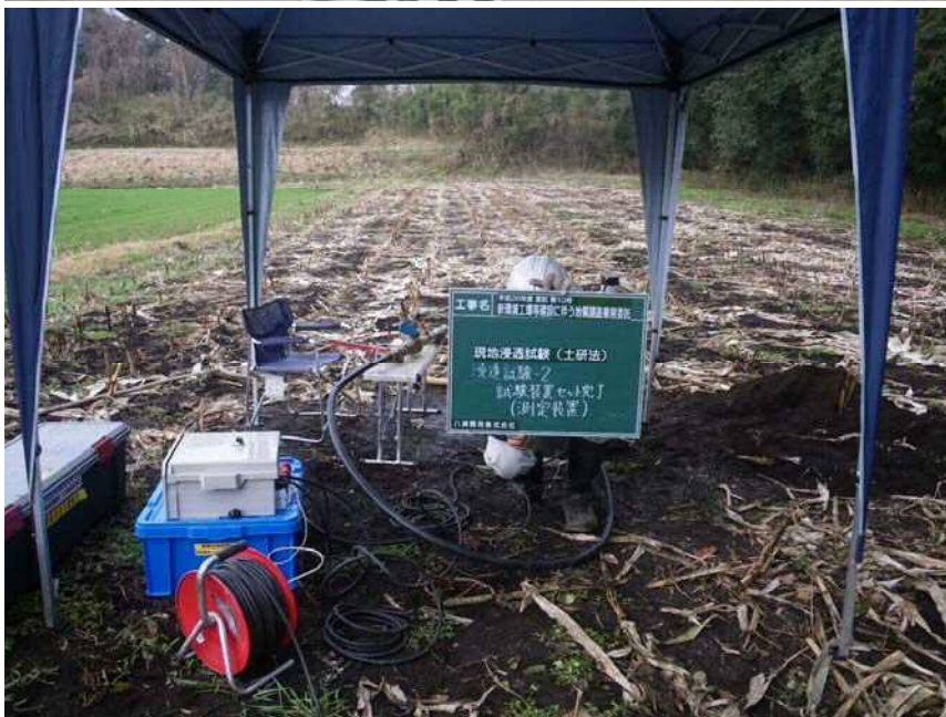
現場浸透試験(土研法)2 試験装置セット完了 測定装置
