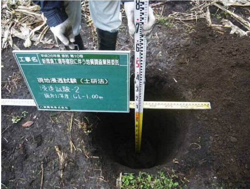
現場浸透試験(土研法)2
