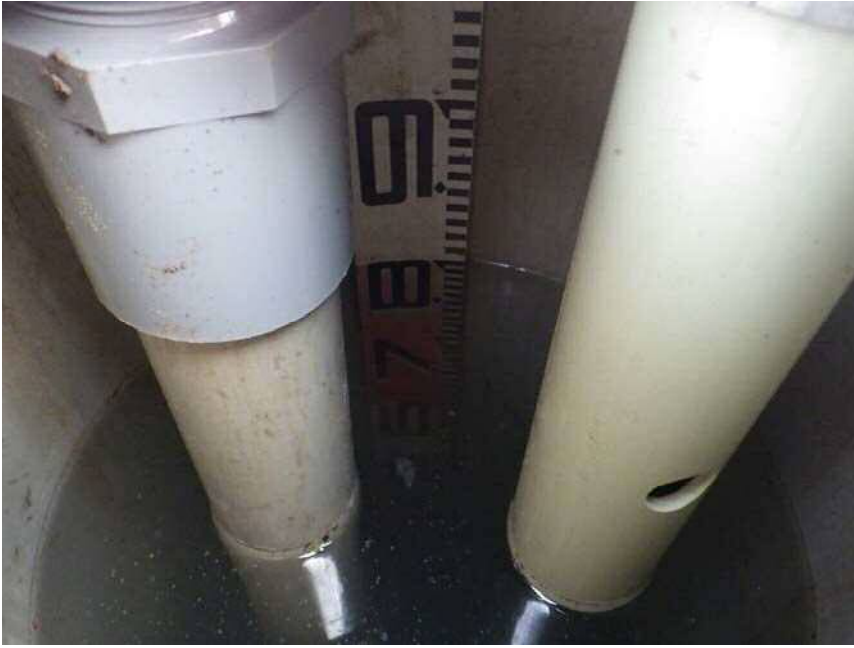
現場浸透試験(土研法)3 測定状況
