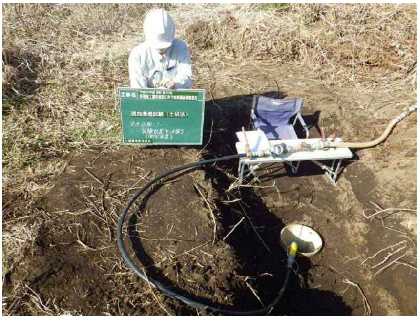
現場浸透試験(土研法)1 試験装置セット完了 測定装置
